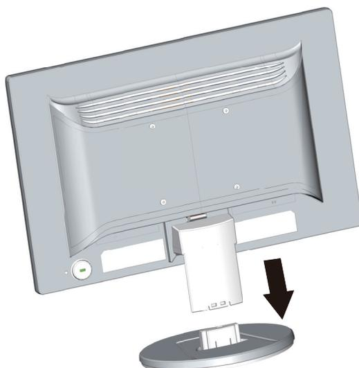
5. Откроются четыре резьбовых отверстия на задней панели монитора. Эти отверстия предназначены для присоединения с помощью винтов поворотного кронштейна или другого настенного крепления к задней панели монитора.
