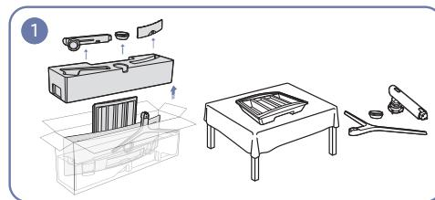
Снимите верхнюю и переднюю прокладки, а затем положите переднюю прокладку на стол.
