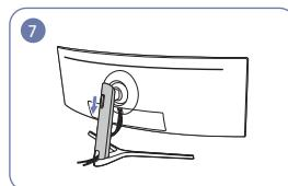
Сдвигайте ЗАДНЮЮ КРЫШКУ СТОЙКИ ПОДСТАВКИ вниз, пока она полностью не закроет шейку подставки.
