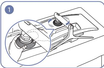
Поверните ВЕРХНЮЮ ЗАДНЮЮ КРЫШКУ против часовой стрелки.
