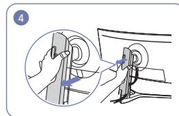
Удалите ЗАДНЮЮ КРЫШКУ СТОЙКИ ПОДСТАВКИ, потянув ее в направлении, как показано на рисунке.
