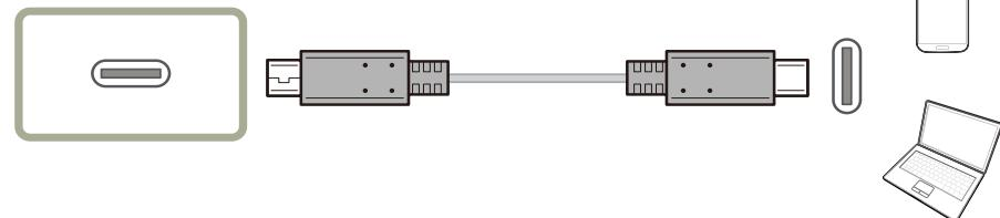
Порт USB Type-C поддерживает функцию передачи питания, данных и видеосигнала DP по кабелям USB.
