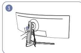
Нажмите на ЗАДНЮЮ КРЫШКУ СТОЙКИ ПОДСТАВКИ в направлении, как показано на рисунке.
