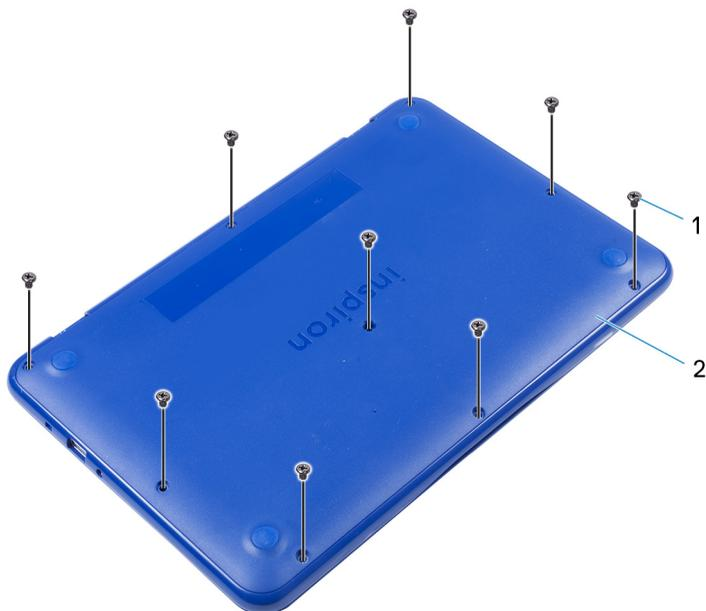
**Рисунок 2. Извлечение винтов**
