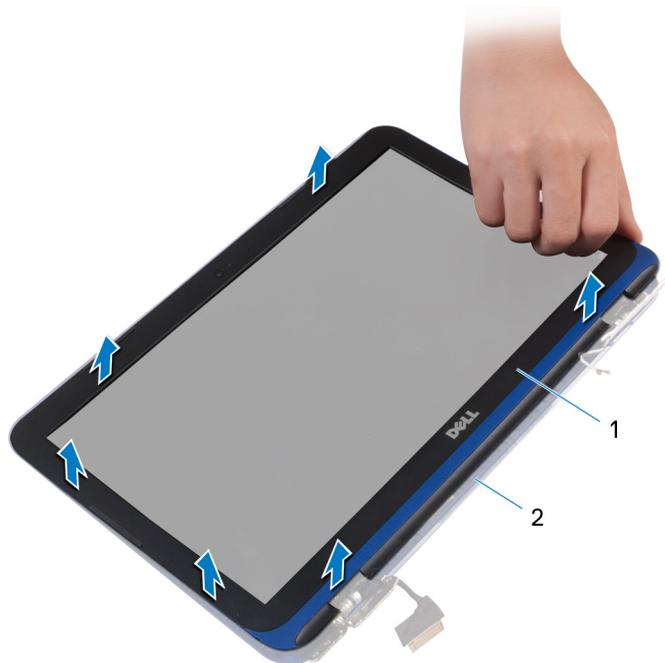
**Рисунок 33. Снятие лицевой панели дисплея**
