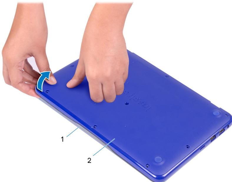
**Рисунок 3. Снятие нижней крышки**
