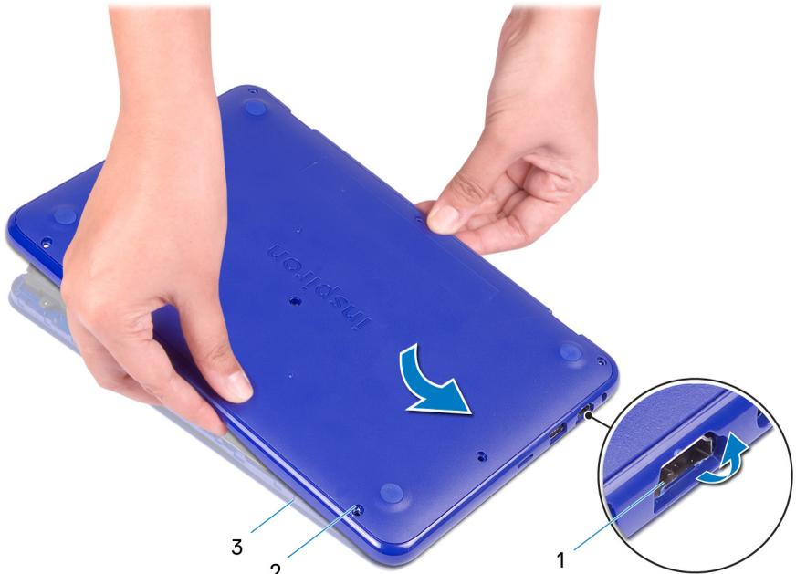
**Рисунок 5. Снятие нижней крышки**
