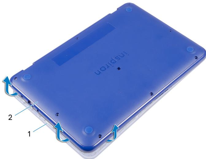
**Рисунок 4. Снятие нижней крышки**
