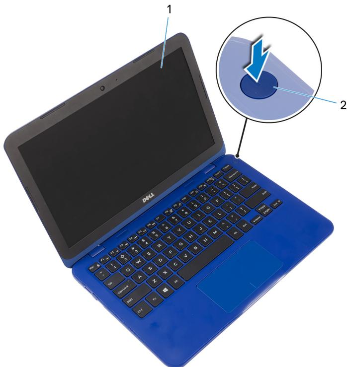
**Рисунок 11. Снятие аккумулятора**
