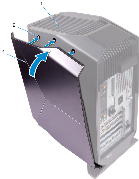
Рисунок 7. Установка правой крышки
