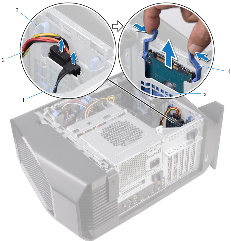
Рисунок 15. Извлечение жесткого диска
