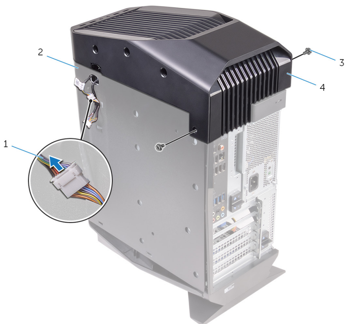
Рисунок 8. Снятие верхней крышки
