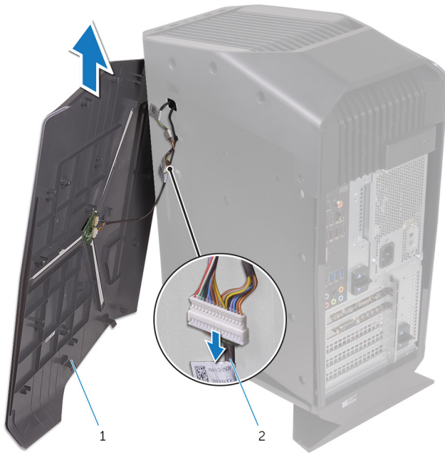
Рисунок 5. Снятие правой крышки
