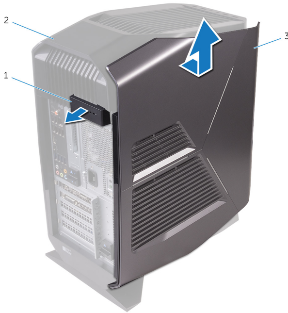
Рисунок 2. Снятие левой боковой крышки
