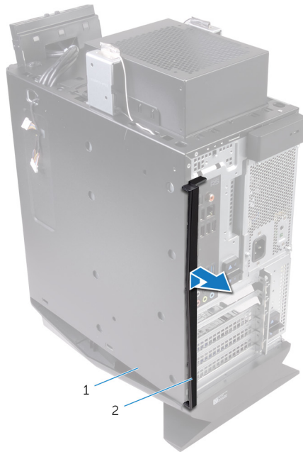
Рисунок 49. Снятие задней облицовочной крышки
