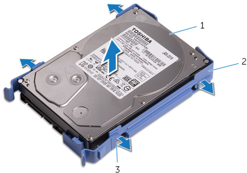
Рисунок 14. Извлечение жесткого диска из каркаса жесткого диска
