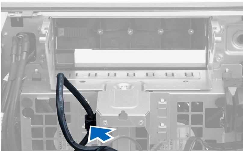
4. Выверните винт, которым металлическая пластина крепится к системному вентилятору.
