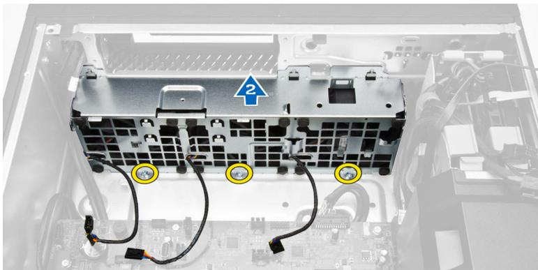
10. Подденьте изолирующие втулки, чтобы извлечь системные вентиляторы из блока системного вентилятора.
