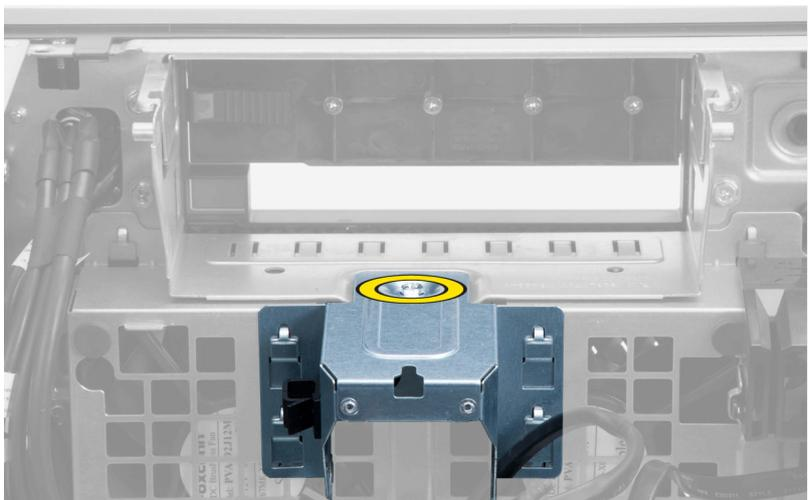
5. Нажмите на защелки с обеих сторон металлической пластины, чтобы высвободить ее.
