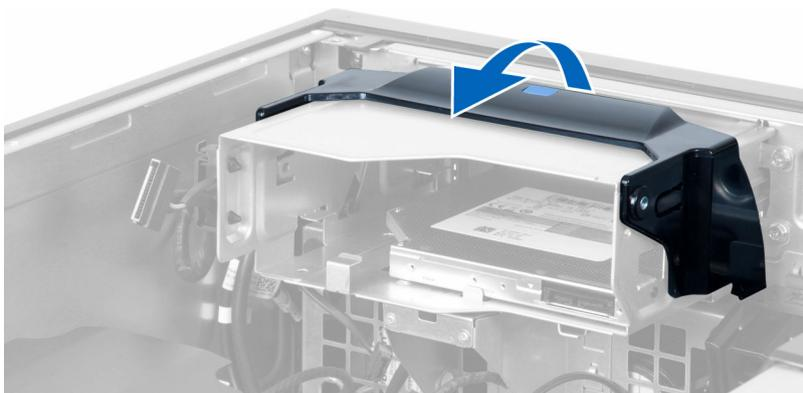
8. Удерживая фиксатор, выдвиньте отсек оптического дисковод из лотка.
