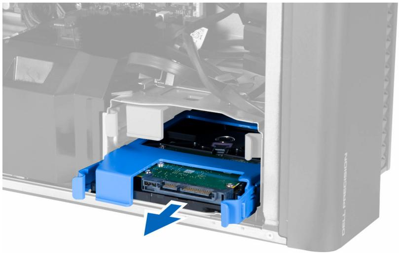
6. Если установлен жесткий диск 2,5", выверните винты и приподнимите жесткий диск , чтобы извлечь его из контейнера.
