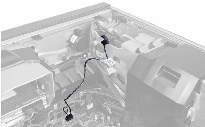
4. Отсоедините кабель температурного датчика жесткого диска от системной платы.
