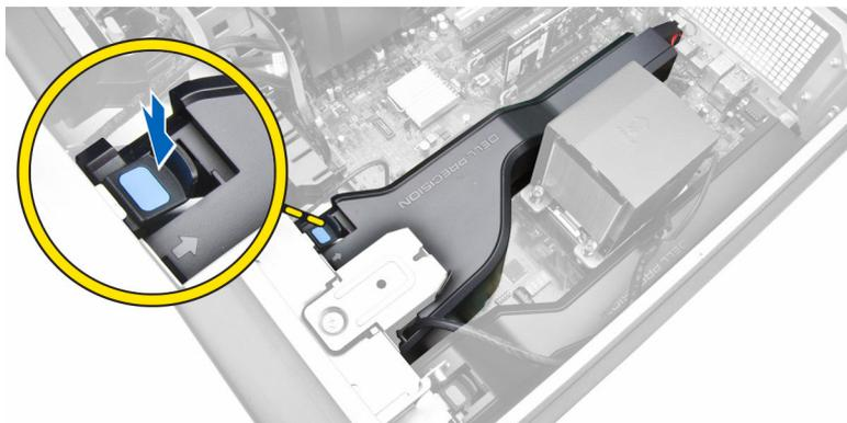
4. Приподнимите защитный корпус модуля памяти вверх, чтобы извлечь его из компьютера.
