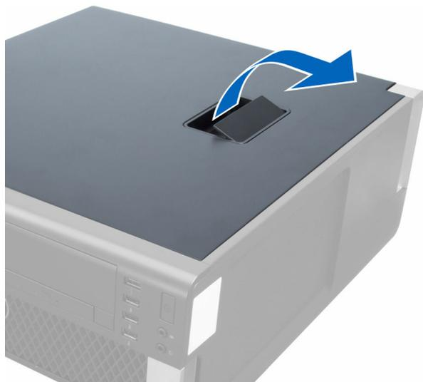
3. Приподнимите крышку под углом в 45 градусов и снимите с компьютера.
