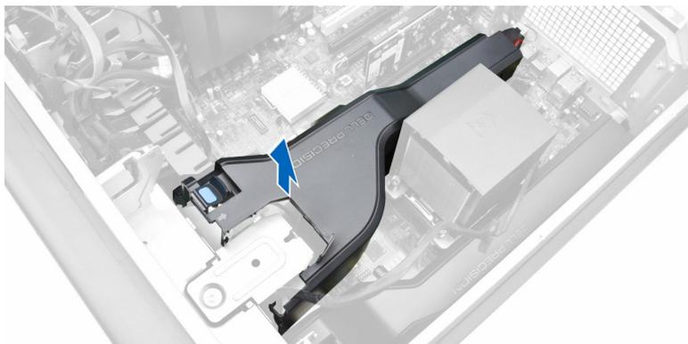
5. Повторите шаги 3 и 4, чтобы извлечь второй защитный корпус модуля памяти из компьютера.
