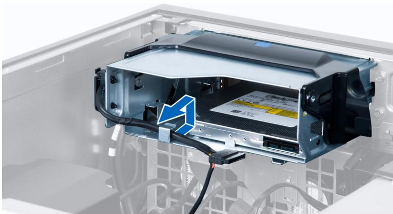
5. Нажмите на карабин, чтобы открыть защелку, удерживающую кабели на боковой поверхности скобы оптического дисковода.
