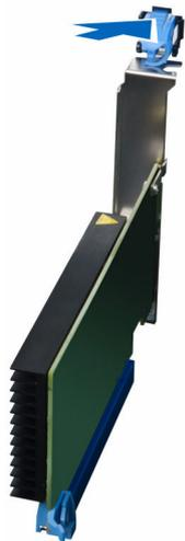
4. Нажмите на фиксатор и извлеките плату PCI из компьютера.
