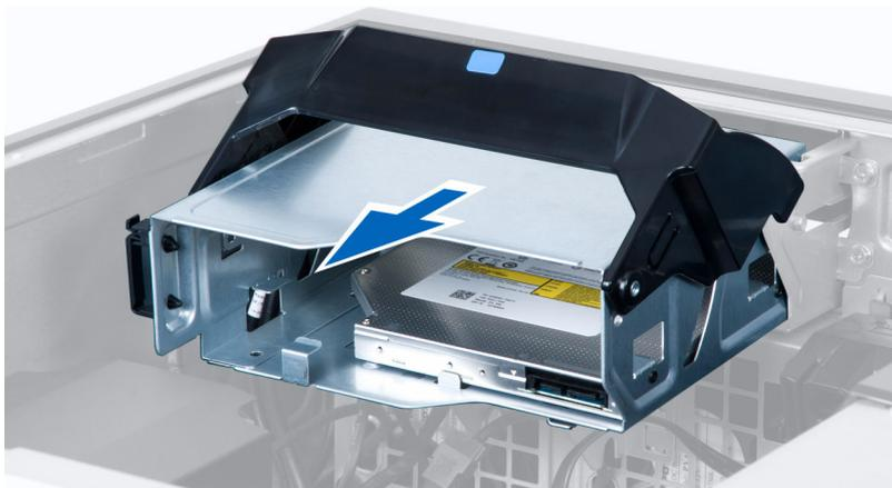
9. Выкрутите винты, с помощью которых оптический дисковод крепится к отсеку для оптических приводов.
