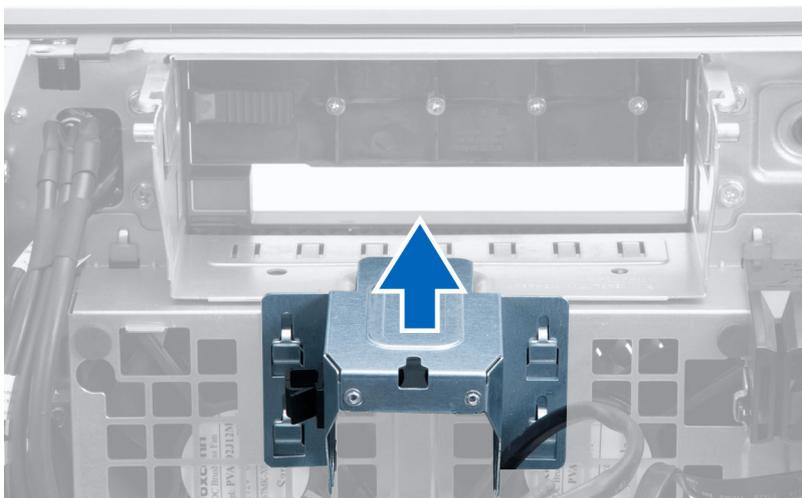
7. Выверните винты, которыми крепится отсек для дисков.
