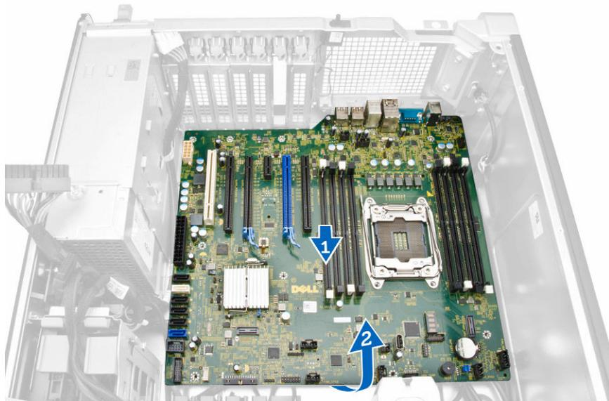
6. Поднимите системную плату вертикально вверх и извлеките ее из компьютера.
