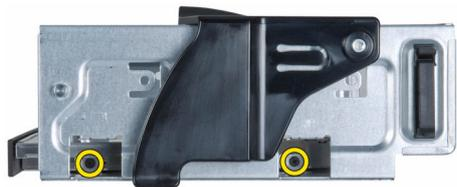
10. Выкрутите винты, с помощью которых оптический дисковод крепится к отсеку для оптических приводов.
