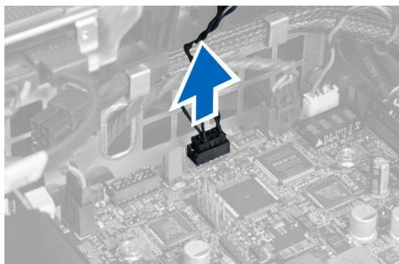
5. Откройте защелку, фиксирующую температурный датчик жесткого диска. В данном случае датчик крепится к жесткому диску.
