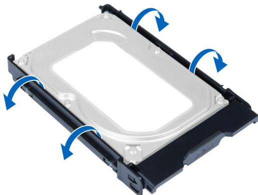
8. Приподнимите жесткий диск в вертикальном направлении, чтобы извлечь его из скобы жесткого диска.
