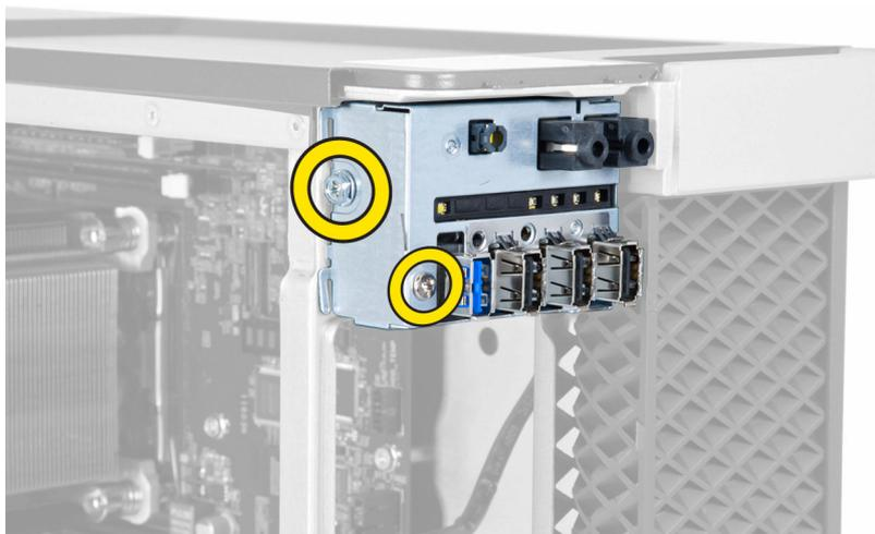
4. Извлеките отсек для панели ввода-вывода из корпуса.
