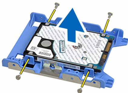
7. Если установлен жесткий диск 3,5", отогните скобу жесткого диска с обеих сторон, чтобы освободить жесткий диск.
