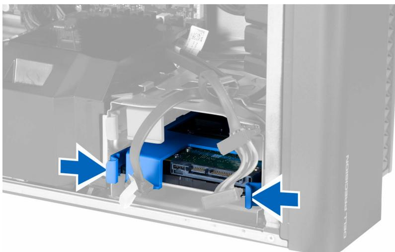
5. Выдвиньте жесткий диск из отсека.
