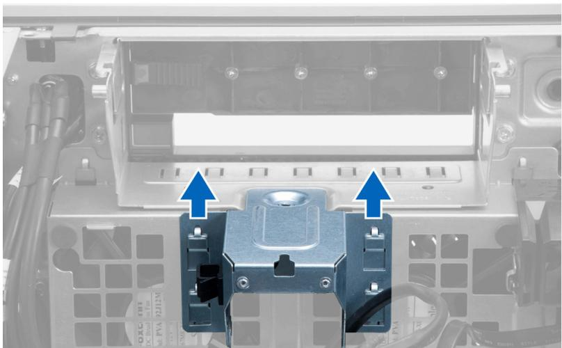
6. Выньте металлическую пластину из корпуса.
