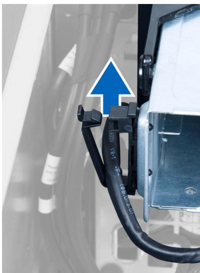
7. Поднимите фиксатор на верхней части отсека для оптического дисковод.
