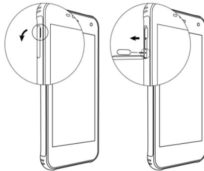
2. Установите SIM-карту(ы) в разъем SIM1 и (или) SIM2, как показано на рисунке и установите держатель SIM/microSD-карт в смартфон.
