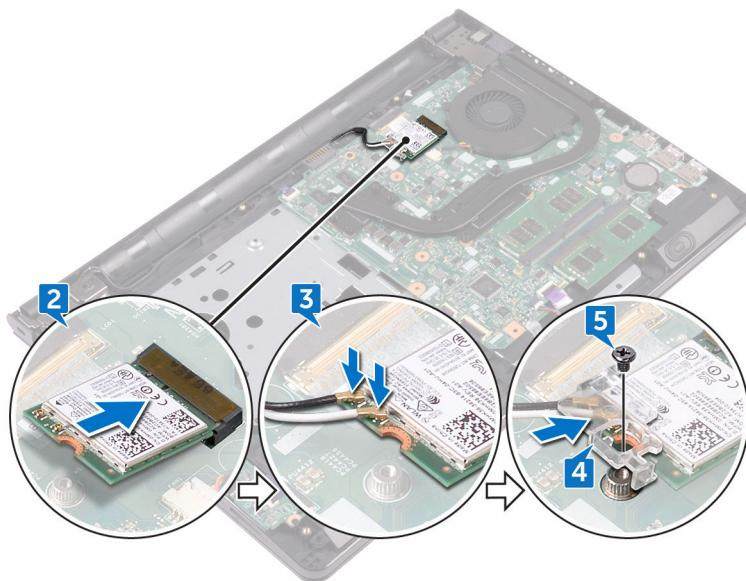
4 Совместите отверстие для винта на консоли платы беспроводной сети с отверстием для винта на самой плате и на системной плате.
