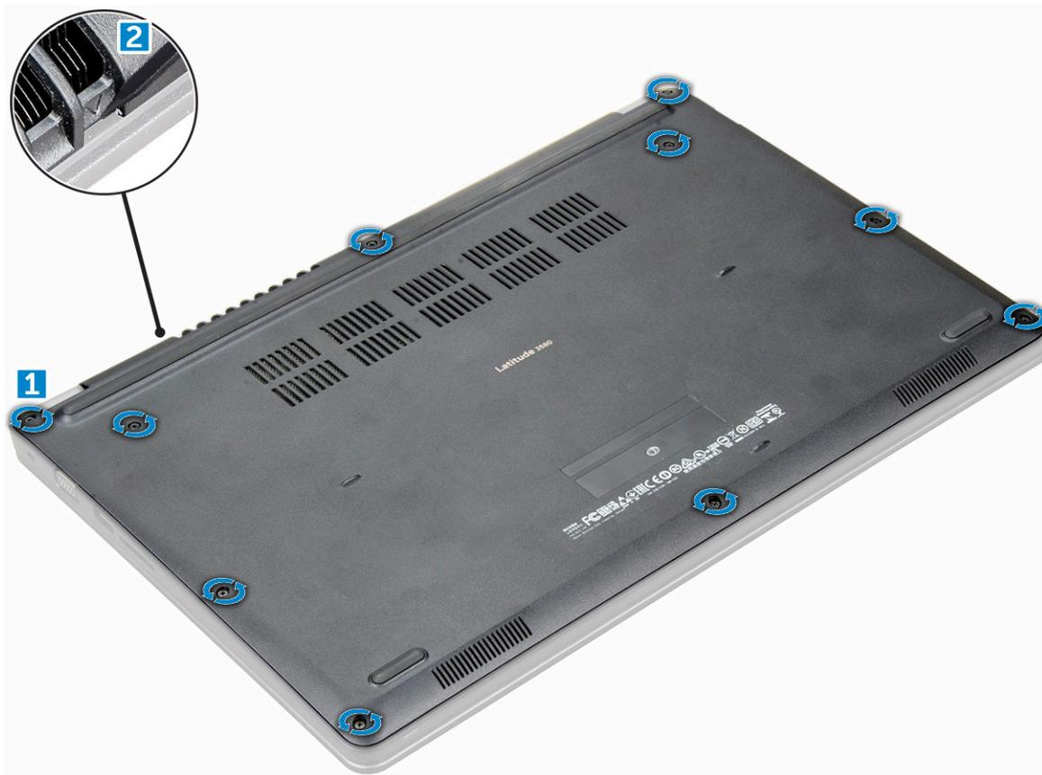
3 Снимите нижнюю крышку с компьютера движением вверх.
