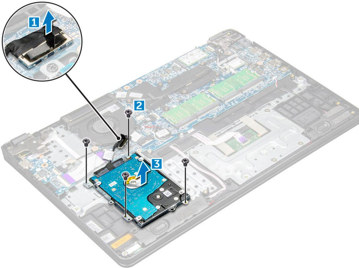
4 Отсоедините соединительную планку кабеля жесткого диска.
