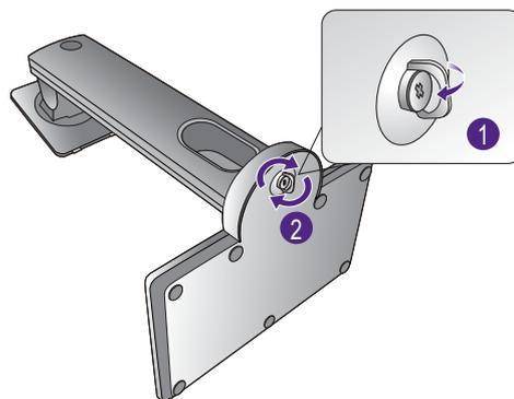
Совместите кронштейн подставки с монитором и затем сдвиньте их (1), чтобы они со щелчком вошли в зацепление друг с другом (2).
