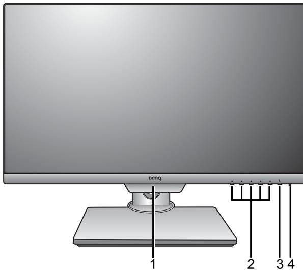
1. Датчик света/Есо-датчик
