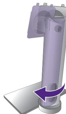
Затяните винты снизу подставки монитора, как показано. А затем поверните подставку против часовой стрелки лицевой стороной вперед.
