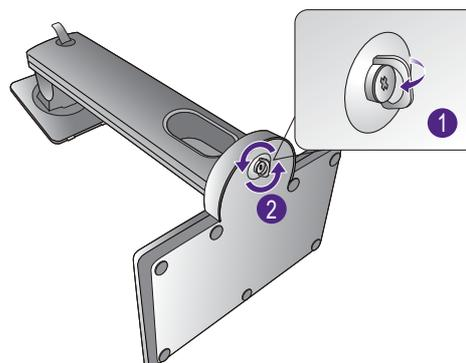
Поворачивайте подставку против часовой стрелки до упора.
