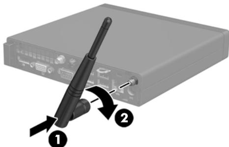
19. Подсоедините кабели внешней антенны к модулю WLAN.
