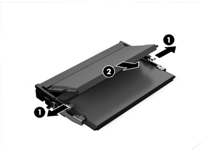
3. Вставьте новый модуль памяти в гнездо под углом примерно 30° (1), затем с достаточным усилием нажмите на модуль памяти (2), чтобы защелки встали на место.
