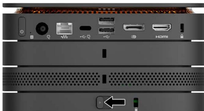
10. Установите защитный тросик в гнездо на держателе VESA для предотвращения разблокировки фиксатора быстрого разъединения и отсоединения модулей.
