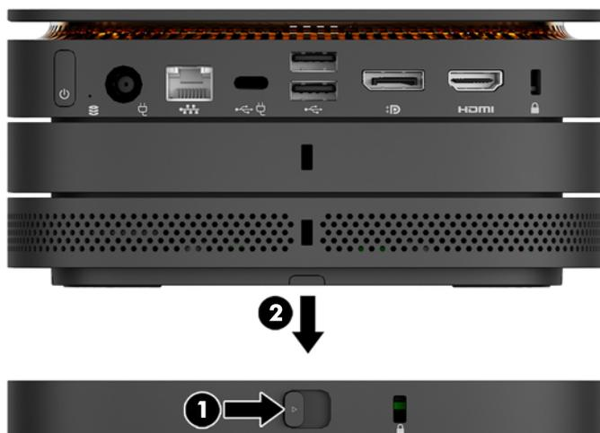
9. Сдвиньте фиксатор быстрого разъединения на задней стороне держателя VESA в положение блокировки, чтобы зафиксировать все модули относительно друг друга.
