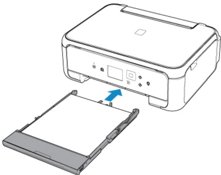
После установки кассеты в принтер на ЖК-дисплее отобразится экран регистрации информации о бумаге для кассеты.
