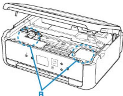
7. Закройте модуль сканирования / крышку.
