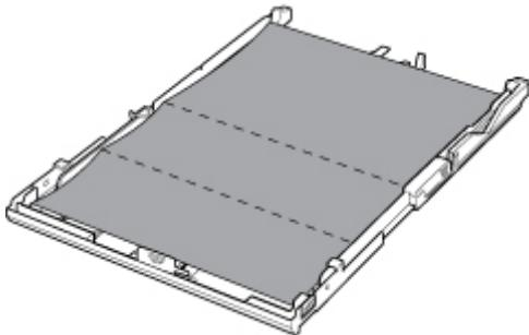
11. Установите крышку кассеты и затем вставьте кассету в принтер.
