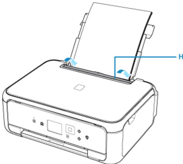
После закрытия крышки отверстия для подачи на ЖК-дисплее отображается экран регистрации информации о бумаге для заднего лотка.
