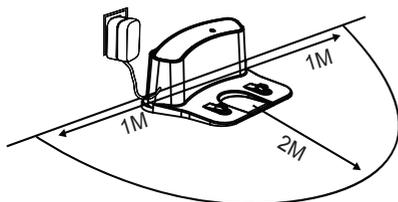
Установите зарядную станцию у стены и уберите все препятствия в пределах 1 метра с обеих сторон и 2 метров впереди.
