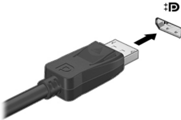
2. Другой конец кабеля подключите к цифровому устройству отображения.
