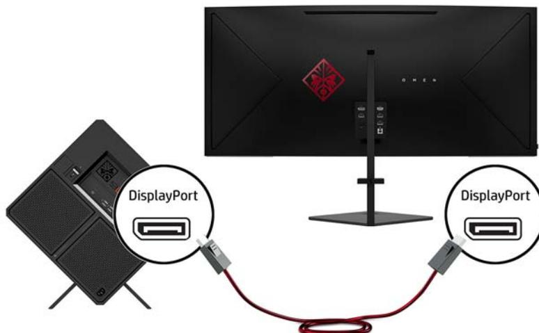
3. Подсоедините один конец кабеля Mini DisplayPort к порту DisplayPort на задней панели монитора, а другой конец – к порту Mini DisplayPort на устройстве-источнике (кабель не прилагается).
