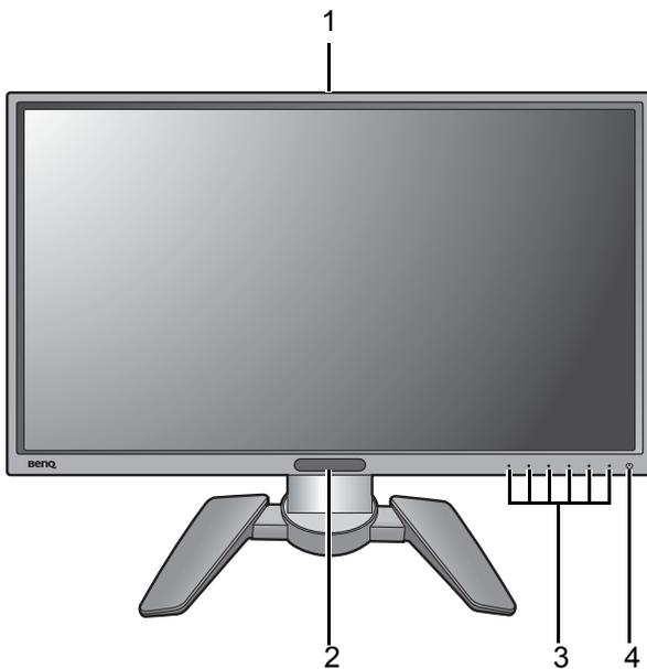
1. Датчик цветовой температуры (см. [Автоматическая регулировка цветовой температуры вна стр. 36](#))
