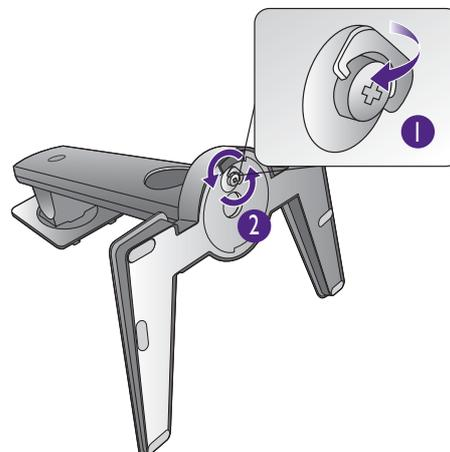
Поворачивайте подставку против часовой стрелки до упора.
