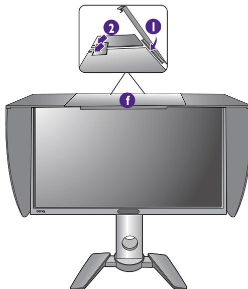
8. Чтобы с помощью колориметра откалибровать цвет дисплея, сдвиньте деталь **f** влево, чтобы высвободить место для колориметра.
