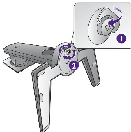
Совместите кронштейн подставки с монитором и затем сдвиньте их (1), чтобы они со щелчком вошли в зацепление друг с другом (2).
