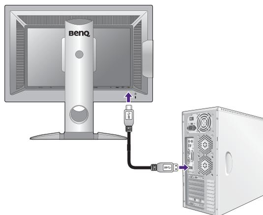
Подключите USB-устройства к другим (выходным) USB-разъемам монитора. Через эти выходные USB-разъемы передаются данные между подключенными USB-устройствами и входным разъемом.
