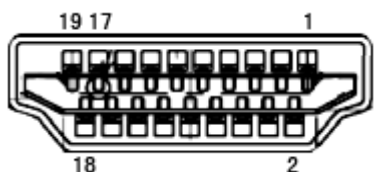
19-контактный кабель для передачи сигналов цветного изображения
