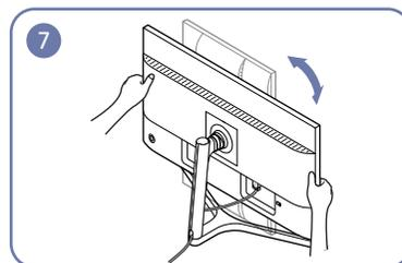
Поверните устройство в горизонтальное положение.
