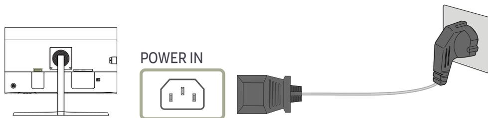
Для работы с устройством подключите кабель питания к электрической розетке и порту POWER IN на устройстве.
