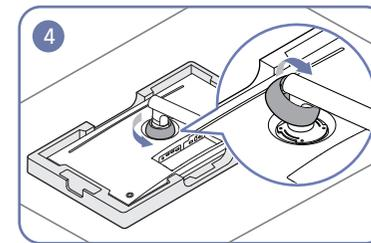
Поверните заднюю поворотную крышку подставки против часовой стрелки, а затем потяните ее вверх для отсоединения от задней крышки.
