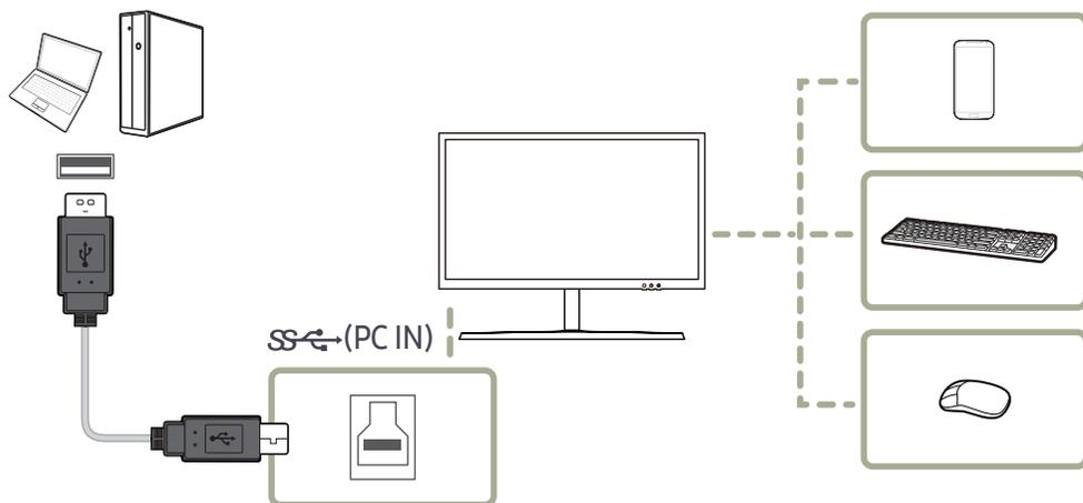
Если к компьютеру подключено несколько устройств — источников сигнала, то множество кабелей вокруг ПК может создавать беспорядок. Подключение устройств непосредственно к изделию позволяет решить эту проблему.
