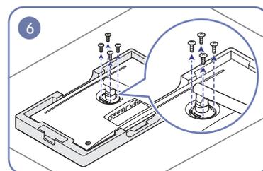
Удалите 4 винта, подсоединяющие шейку подставки к устройству, а затем поднимите и снимите шейку подставки.
