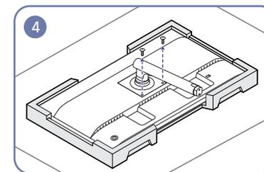
Отверните винт на задней панели устройства.
