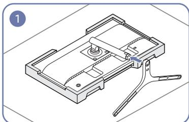
Положите на пол защитный пенопластовый материал (стирофом), входящий в комплект, и разместите на нем устройство экраном книзу, как показано на рисунке. При отсутствии защитного материала используйте толстый коврик.
