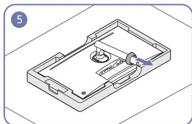
Удалите заднюю поворотную крышку подставки после ее отсоединения от задней крышки.
