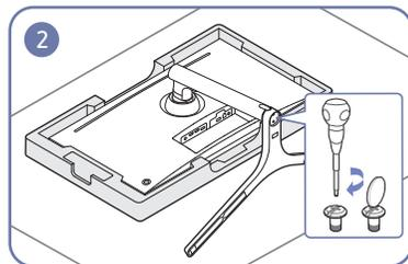
Установите основание подставки и затяните винты на нижней части основания подставки.
