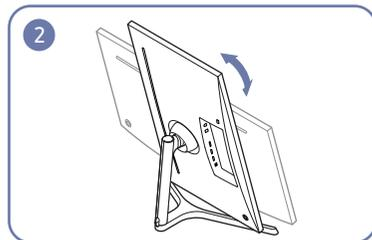
Поверните устройство в самое высокое вертикальное положение.
