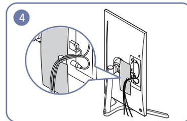
Расположите кабели, учитывая сгибаемость, и извлеките кабели из НИЖНЕЙ КРЫШКИ ЗАДНЕЙ ПАНЕЛИ.
