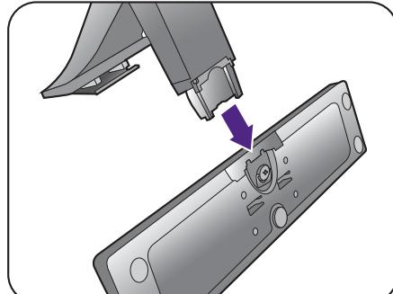
Затяните винт снизу подставки монитора, как показано.
