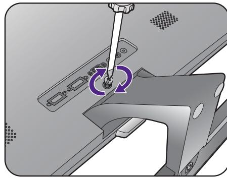
Осторожно поднимите монитор, переверните его и установите его на подставку на плоской ровной поверхности.
