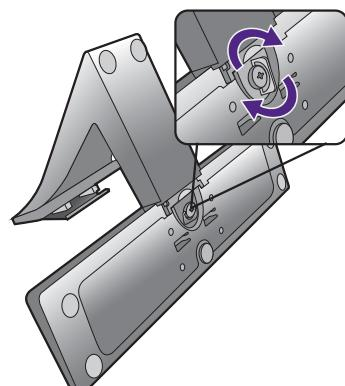
Совместите кронштейн подставки с монитором и затем сдвиньте их, чтобы они со щелчком вошли в зацепление друг с другом.
