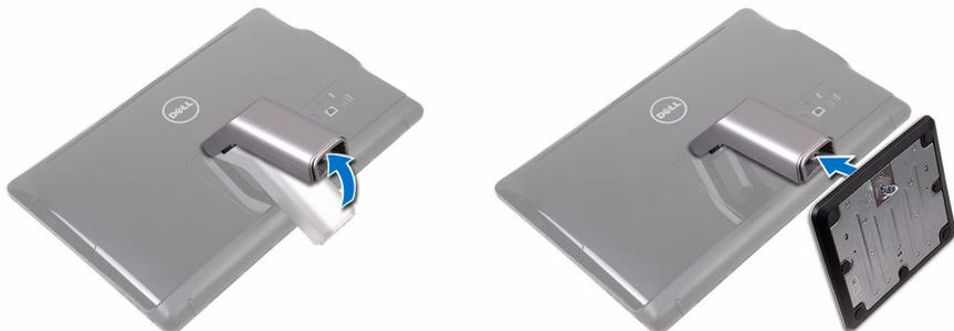
б) Затяните невыпадающий винт, чтобы прикрепить основание к пластине подставки.
