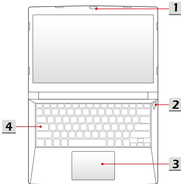
1. Веб-камера / Индикатор веб-камеры / Встроенный микрофон
