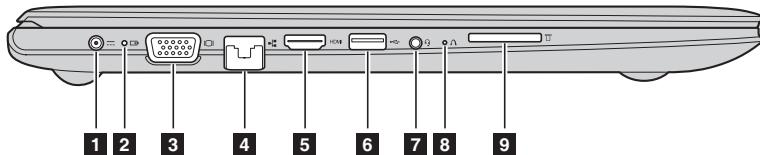
**1 Гнездо адаптера питания** Предназначено для подключения адаптера питания.
