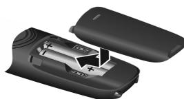
Как открыть крышку отсека для аккумуляторов, например для замены аккумуляторов:
