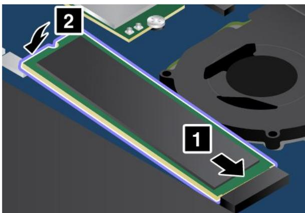
8. Закрепите новый твердотельный диск M.2 винтом.
