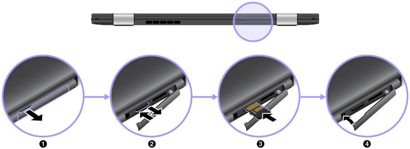
1. Откройте крышку гнезда карты microSD на задней панели компьютера.
