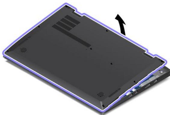
6. Снимите крышку корпуса.
