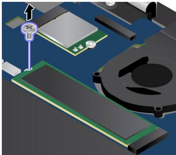
6. Извлеките твердотельный диск M.2.
