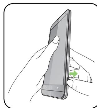
3. Приподнимите крышку и снимите ее.
