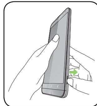
3. Для снятия задней крышки подцепите ее за углубление и сдвиньте вверх, затем влево.
