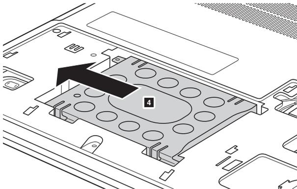
6. Извлеките жесткий диск, заключенный в металлический каркас 5.
