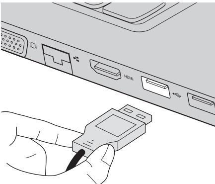
При первом подключении устройства USB к порту USB на компьютере Windows автоматически установит драйвер для этого устройства. После установки драйвера можно отсоединять и подсоединять устройство без выполнения дополнительных действий.
