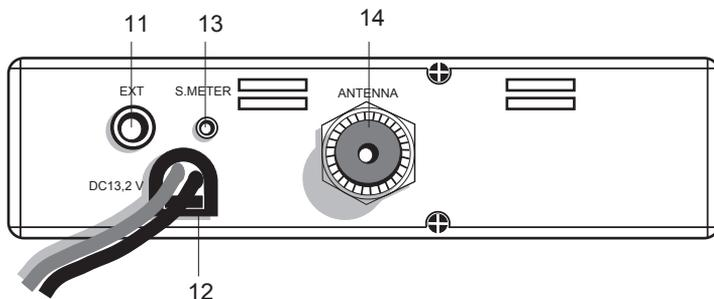
11. **Разъем «EXT».** Предназначен для подключения внешнего динамика.
