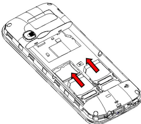
✓ Установка SIM-карт необходимо производить в предназначенные для них слоты так, чтобы их металлические контакты были направлены вниз, а угловой срез SIM-карт совпадал с инструкцией по установке SIM на корпусе телефона.
