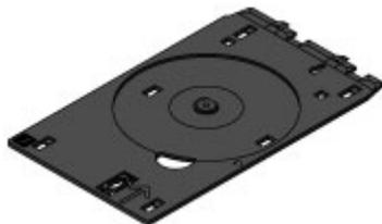
\* Воспользуйтесь лотком для диска с обозначением «J» на поверхности. Лоток для диска устанавливается на задней панели кассеты (верх.).
