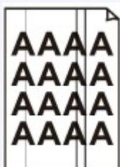
**Проверка 8** Ролик подачи бумаги загрязнен?
