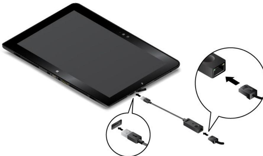
ThinkPad USB 3.0 Ethernet Adapter оборудован двумя индикаторами состояния сети. Если зеленый индикатор горит, планшетный ПК подключен к локальной сети. Когда желтый индикатор мигает, выполняется передача данных.
