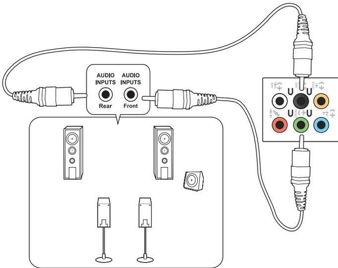
**Подключение 5.1-канальной акустической системы**
