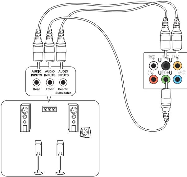
**Подключение 7.1-канальной акустической системы**
