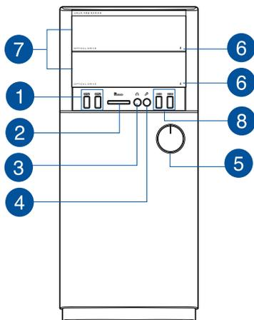
**1** **Порты USB 3.0.** Подключение USB-устройств например, клавиатуры, мыши, принтера, сканера, PDA и других устройств.
