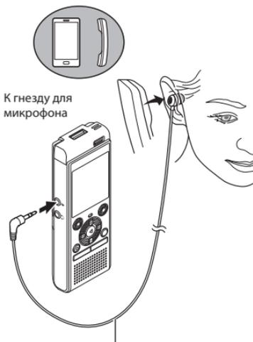
Пример: Устройство приема входящих телефонных звонков TR8 (опциональные)
