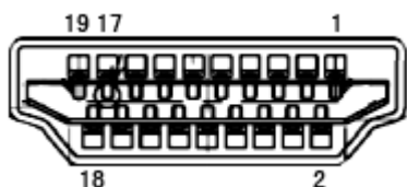
19-контактный кабель для передачи сигналов цветного изображения
