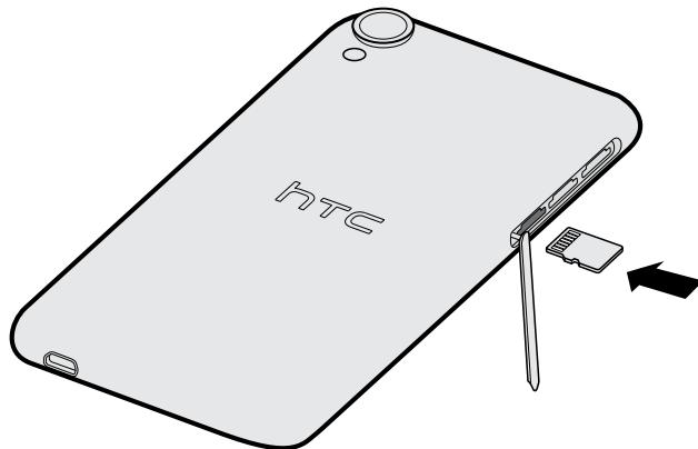
3. Чтобы закрыть крышку слотов, задвиньте пластиковый шарнир внутрь боковой стороны корпуса и прижмите крышку до фиксации со щелчком.
