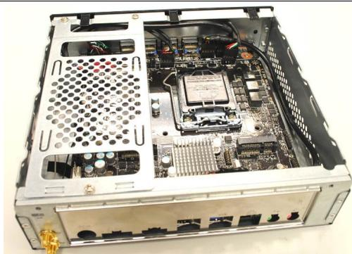
Шаг 4 Открутите три винта держателя жесткого диска. Сохраните винты для последующего использования.
