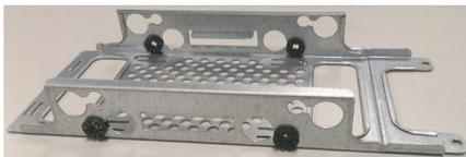
Шаг 3 Вдвиньте жесткий диск так, чтобы он занял правильное положение в держателе. Зафиксируйте жесткий диск винтами при помощи отвертки.
