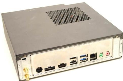
Шаг 2 Открутите два винта, расположенных на задней части. Сохраните винты для последующего использования.
