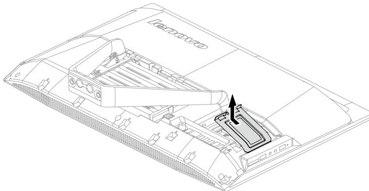
7. Откройте защелки на обеих сторонах гнезда модуля памяти и осторожно вытащите модуль памяти из гнезда. Все модули памяти извлекаются одним и тем же способом.
