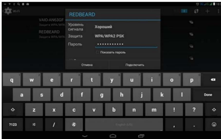
Введя пароль, воспользуйтесь кнопкой «Подключить». Устройство автоматически подключится к сети, а сетевой маршрутизатор присвоит ему IP адрес. После чего, устройство присвоит сети статус «Подключено» и выведет соответствующее уведомление в строке состояния на основном рабочем столе. Также, при однократном касании названия сет устройство покажет статус подключения, согласно изображениям ниже
