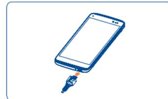
Подключите зарядное устройство к телефону и стандартной бытовой розетке переменного тока (220 В, 50 Гц), как показано на рисунке. О начале зарядки вас проинформирует включившийся светодиодный индикатор.
