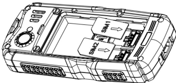
Перед началом установки SIM-карты убедитесь в том, что устройство выключено. Если устройство включено, для его выключения нажмите и удерживайте клавишу Отмена (11 на схеме устройства).
