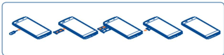
Для установки или извлечения micro-SIM-карты и microSD-карты воспользуйтесь входящим в комплект инструментом для извлечения SIM-карты: вставьте его в небольшое отверстие на крышке слота micro-SIM-карты и слегка надавите на него до щелчка.
