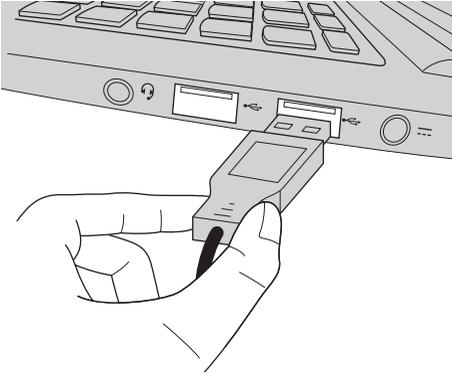
При первом подключении разъема USB к определенному порту USB на компьютере Windows автоматически установит драйвер для этого устройства. После установки драйвера можно отсоединять и подсоединять устройство без выполнения дополнительных действий.
