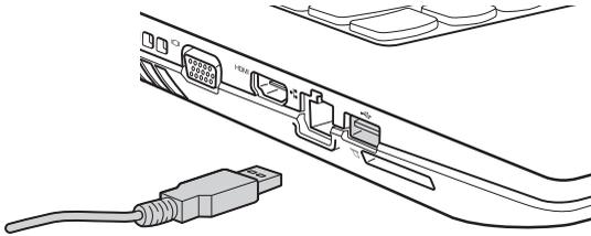
При первом подключении устройства USB к одному из USB-портов компьютера ОС Windows автоматически устанавливает драйвер для данного устройства. После установки драйверов устройство можно подключать и отключать без каких-либо дополнительных действий.
