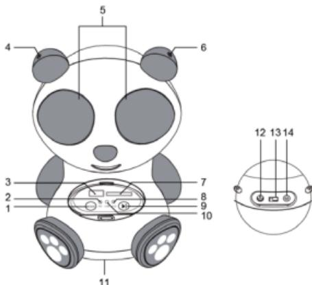
1 Кнопка вибору режиму роботи (SD/USB/AUX)
