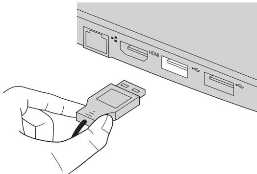
При первом подключении устройства USB к определенному порту USB на компьютере Windows автоматически установит драйвер для этого устройства. После установки драйвера можно отсоединять и подсоединять устройство без выполнения дополнительных действий.
