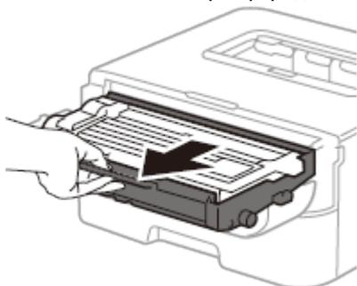
4. Нажмите вниз на фиксатор блокировки и извлеките тонер-картридж из фотобарабана.
