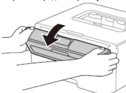
3. Извлеките блок тонер-картриджа и фотобарабана из устройства.
