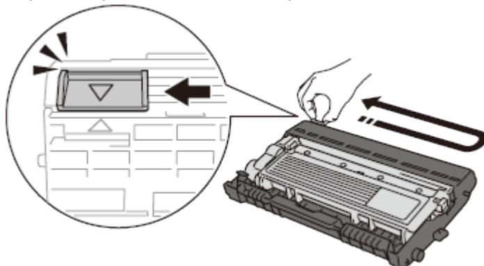
Обязательно верните ползунок в исходное положение (▲). Стрелка на лапке должна быть на одной линии со стрелкой на фотобарабане. В противном случае на напечатанных страницах может появиться вертикальная полоса.
