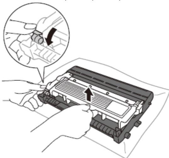
5. Распакуйте новый тонер-картридж и снимите защитную крышку. Вставьте новый тонер-картридж в фотобарабан так, чтобы он зафиксировался на месте со щелчком. При правильной установке
