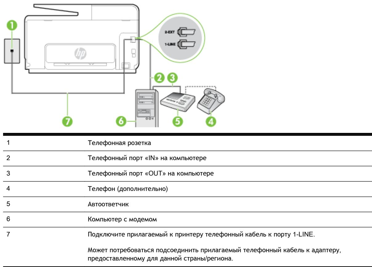
1. Снимите белую заглушку с порта 2-EXT на задней панели принтера.
