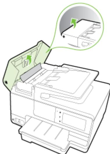
2. Поднимите устройство АПД за выступ, расположенный в передней части.
