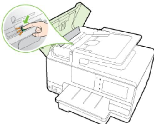
5. Опустите крышку устройства автоматической подачи документов и с усилием нажмите на нее, чтобы крышка зафиксировалась на месте со щелчком.
