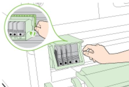
4. Извлеките печатающую головку, приподняв ее и вытянув из принтера.
