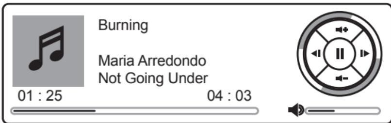
В окне интерфейса плеера отображаются информация о названии файла, исполнителе, альбоме, временная шкала, уровень громкости, рисунок-подсказка об управлении проигрыванием с помощью кнопок навигации.
