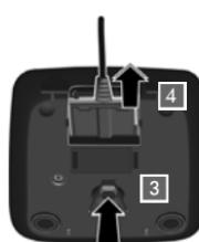
Чтобы отсоединить штекер от зарядного устройства, нажмите кнопку фиксатора **3** и отсоедините штекер **4**.
